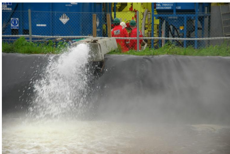
Testpumpen var i stand til at hente 93.000 liter vand op i timen fra 1.200 meters dybde (Foto: Steve Devereaux)
