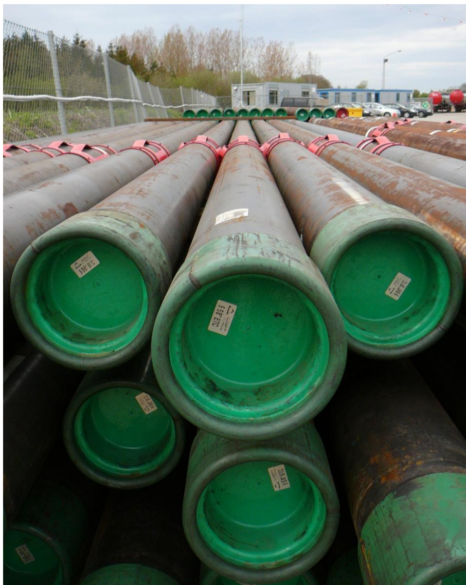
9-5/8 tommer forerør – bemærk de røde "fjeder", som har til formål at holde rørene midt i hullet
