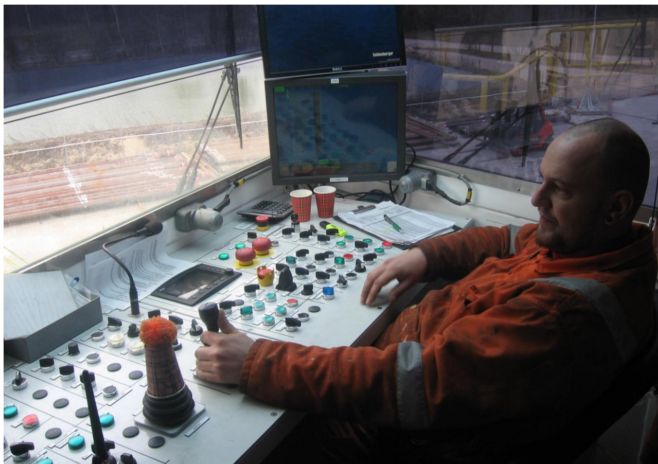
Med et væld af knapper, joysticks og trykfølsomme skærme styrer Driller'en den avancerede borerig
